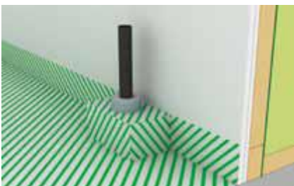
Figur 3 Rör genomföring våningsplan (Säker Vatteninstallation 2011:1 fig. 2.7.2 c)
